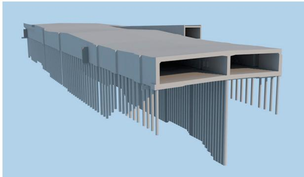
Der hohe Grundwasserspiegel im Bereich zwischen Elbtunnel und S-Bahnbrücke macht einen geschlossenen Tunnel mit kombinierter Pfahlplattengründung erforderlich.
