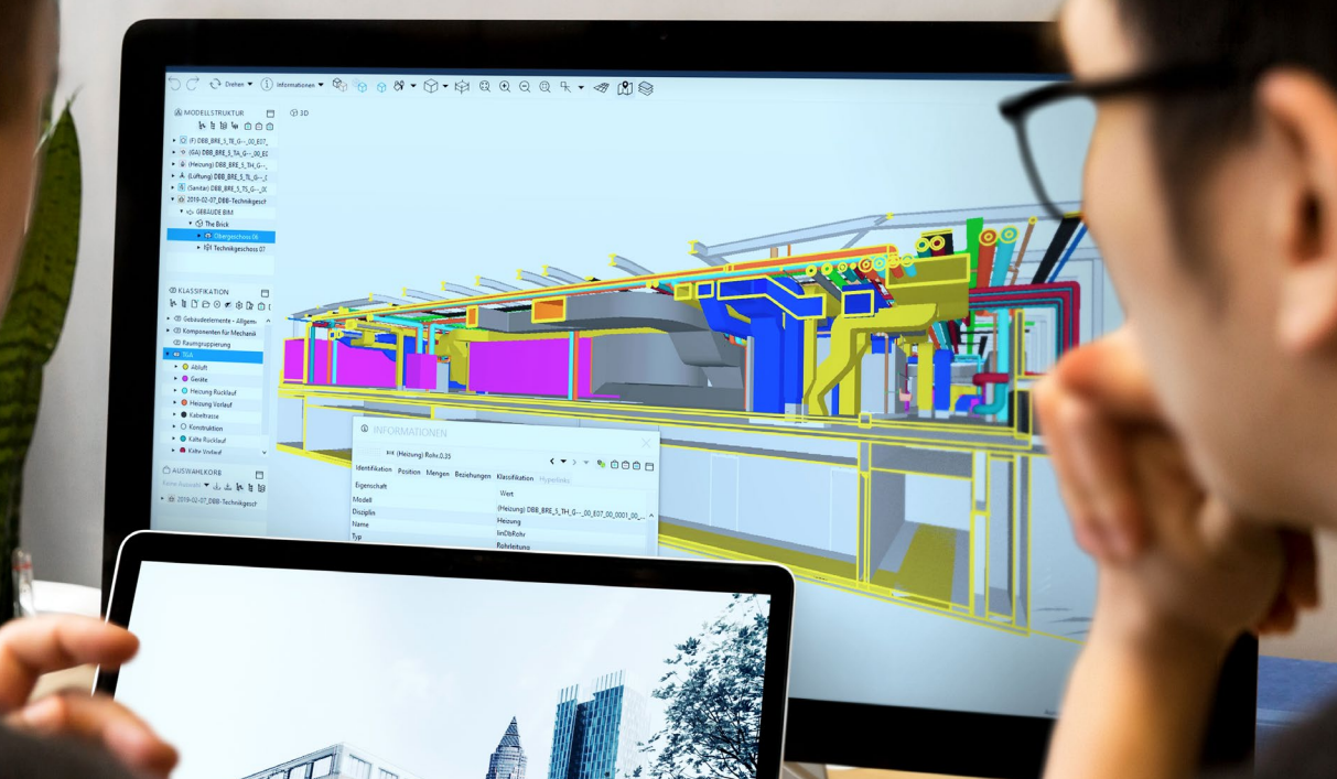
Virtuelle 3D-Kollisionsprüfung. Auf dem Bildschirm: das Technikgeschoss Brick. © Schmidt Plöcker Architekten
