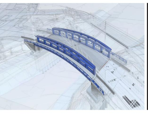
Die seit 1995 stillgelegte Altglienicker Brücke soll endlich durch einen Neubau ersetzt werden. Geplant wird dieser als Stahlverbund-Fachwerk durch die AFRY Deutschland GmbH aus Leipzig. © AFRY
