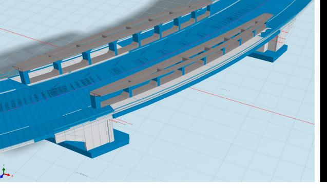
Die Vorzugsvariante beschreibt einen größeren Linksbogen (R = 120 Meter). Eine doppelte Krümmung in Gradiente und Lage verursacht Torsionsspannung. © AFRY
