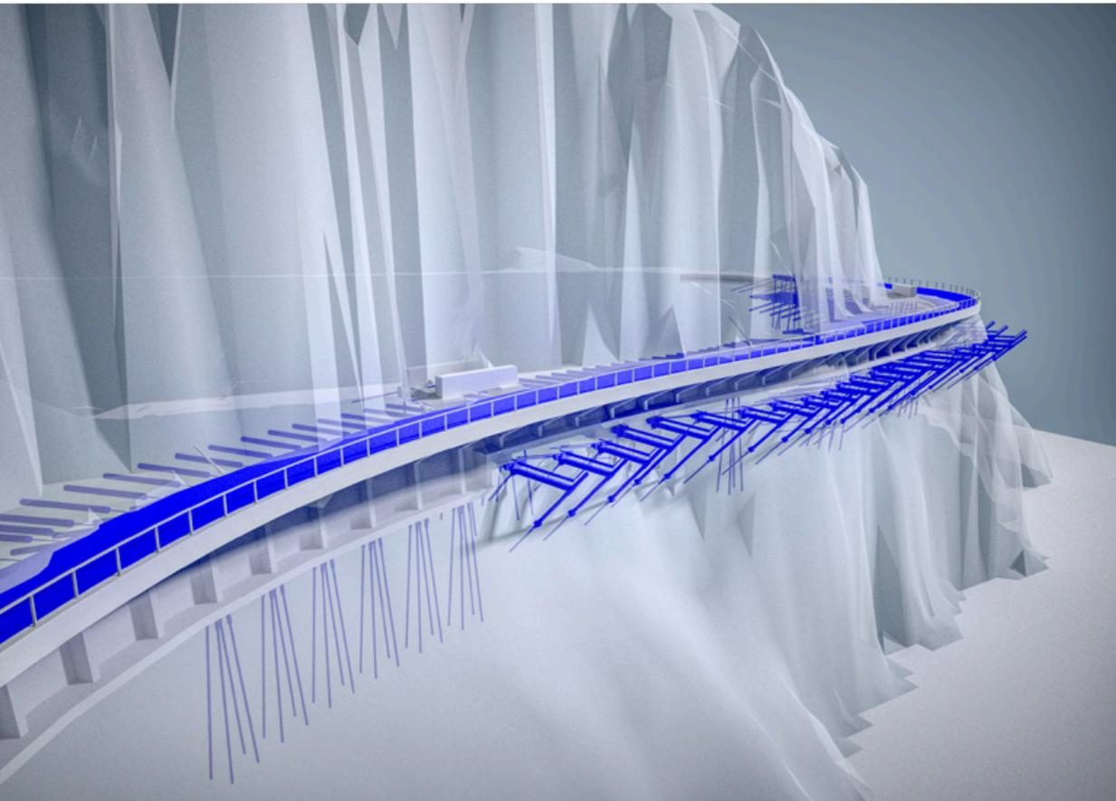
3D-Modell Teilausbau und Sanierung LU K2b Vitznau mit Bauhilfsmassnahmen
